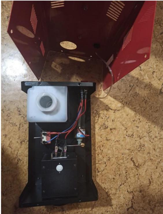
4. Аппарат поворачиваем на левый бок и по середине терморегулятор, у него регулировочный штырь, с фаской, которая показывает в каком режиме нагревательный элемент
